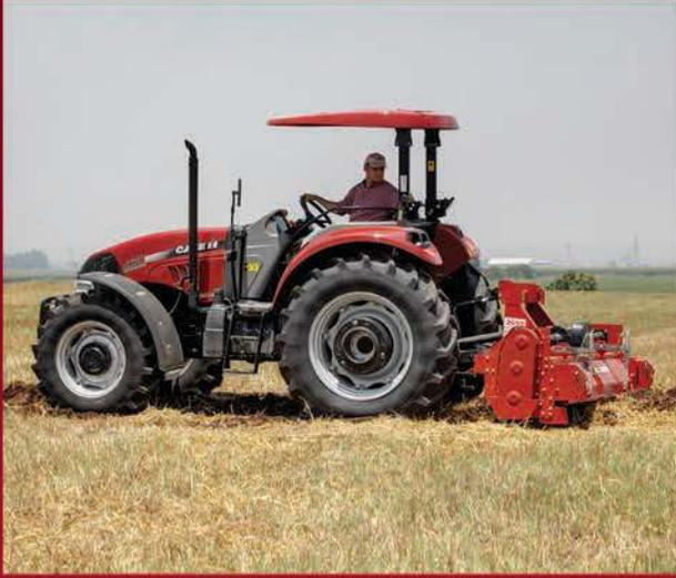
Case IH JX serisi tüm modellerde 540 d/d ve 540E d/d (750 d/d) kuyruk mili seçenekleri standart olarak sunulmaktadır. Sadece 1535 d/d gibi düşük bir devirde devreye giren 540E devir seçeneği sayesinde ekonomik bir kullanımı Case IH JX serisi sizin için garanti altına alacaktır.
