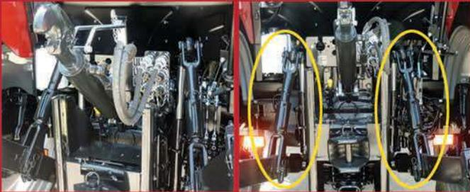
Case IH JX100 ve 110 modellerde standart olarak sunulan ek güç silindirleri ile 4.700 kg'a yükselen hidrolik kaldırma kapasitesi sayesinde pek çok tarımsal ekipman ile etkin bir şekilde çalışacaksınız.
