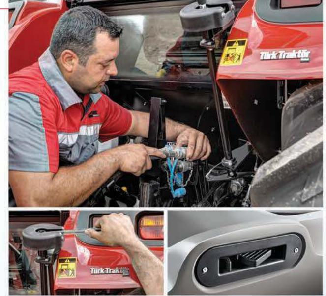
Orta hidrolik kol uygulaması ile kullanıcı kabin içinden orta hidrolik kolu kontrol ederek ekipman bağlamadan hidrolik derinlik ayarına kadar pek çok işlemi etkin bir şekilde gerçekleştirebilmektedir. Harici 2 adet hidrolik güç çıkışı ile kontrol edilen, kullanıcılara pratiklik ve kolay kullanım kazandıran orta hidrolik kol, tüm Case IH JX90/100 ve 110 modellerde standart olarak sunulmaktadır.
