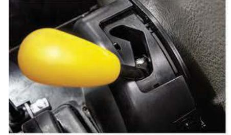
Yumuşak bir kuyruk mili kavramasını sağlayan servo kuyruk mili uygulaması, aynı zamanda traktörün durdurulması sonrasında otomatik olarak devre dışı kalarak güvenli bir kullanımı da sizlere sunmaktadır. Servo kuyruk mili uygulaması tüm powershuttle modellerde standart olarak sunulmaktadır.
