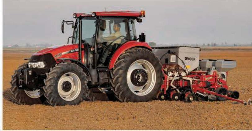
Case IH JX110 modelinde 540 d/d – 1000 d/d kuyruk mili seçeneği isteğe bağlı olarak sunulmaktadır. Bu devir seçeneği sayesinde yüksek kuyruk mili devri gerektiren dik rotovatör, balya makinası gibi tarımsal ekipmanlar ile etkin olarak çalışabilmeniz sağlanmaktadır.
